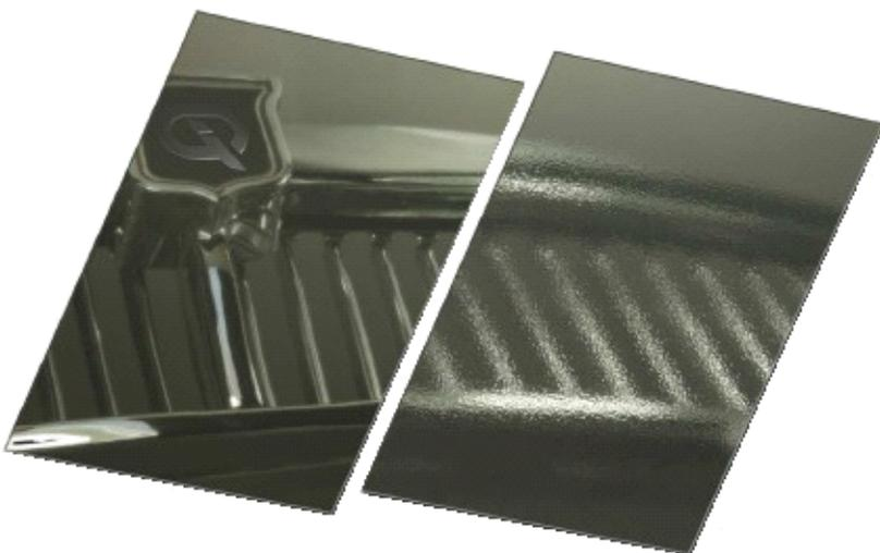
表面纹理会减弱表面成像的质量，而不影响光泽度值。上面2块面板用传统的光泽仪测量得到的光泽度值是相同的。
